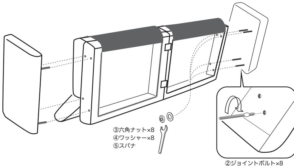
4. ②(アーム)の内側にジョイントボルトを取り付けます(計8ヶ所)。
